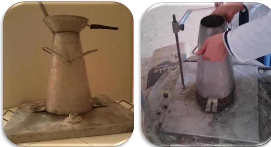
**Figure IV. 5:**L'essai d'affaissement au cône d'Abrams
