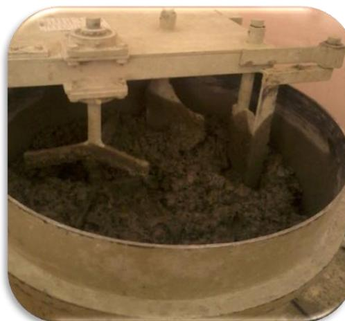
**Figure IV. 4 :** Malaxage du béton hydraulique
