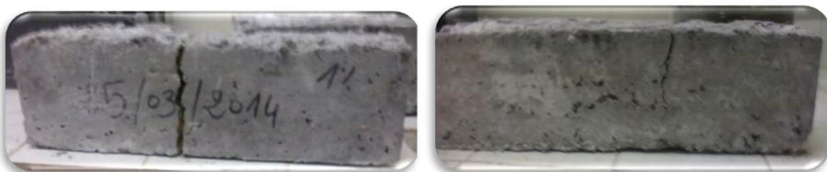
**Figure IV. 14:** Rupture d'éprouvette prismatique après l'essai de traction par flexion (béton fibré)
