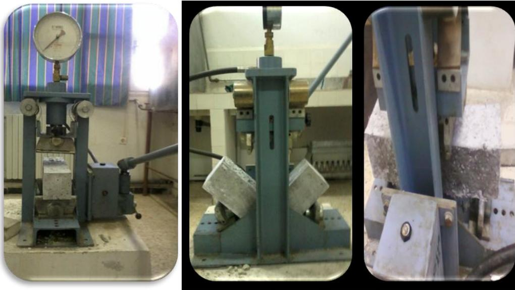
**Figure IV. 12:**Essais de traction par flexion sur des éprouvettes prismatiques (sans fibre et fibré)
