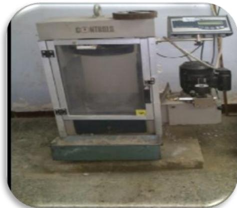
**Figure IV. 16 :** Machine d'essai de compression
