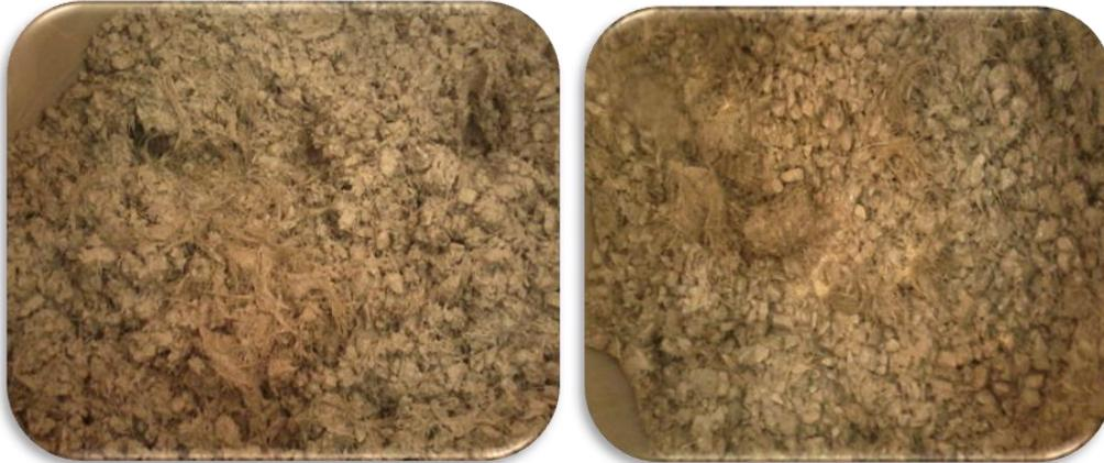
**Figure IV. 6:**Malaxage du béton de fibres de filasse
