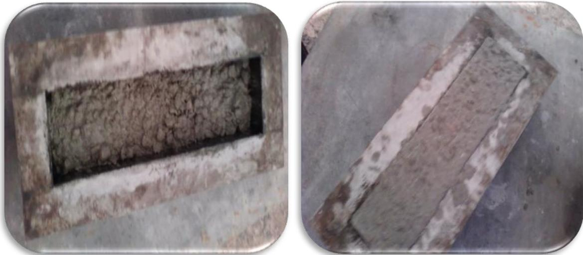
**Figure IV. 8:**Moulage des éprouvettes.
