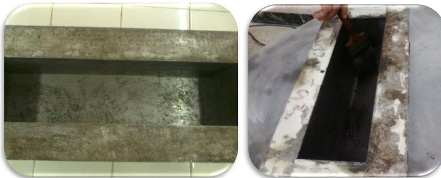
**Figure IV. 2 :** Lubrifiant des parois des éprouvettes par huile.
