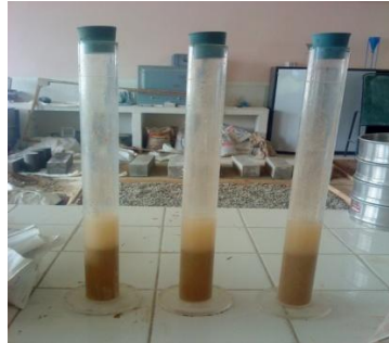
Figure III. 10: Essai d'équivalent de sable.
