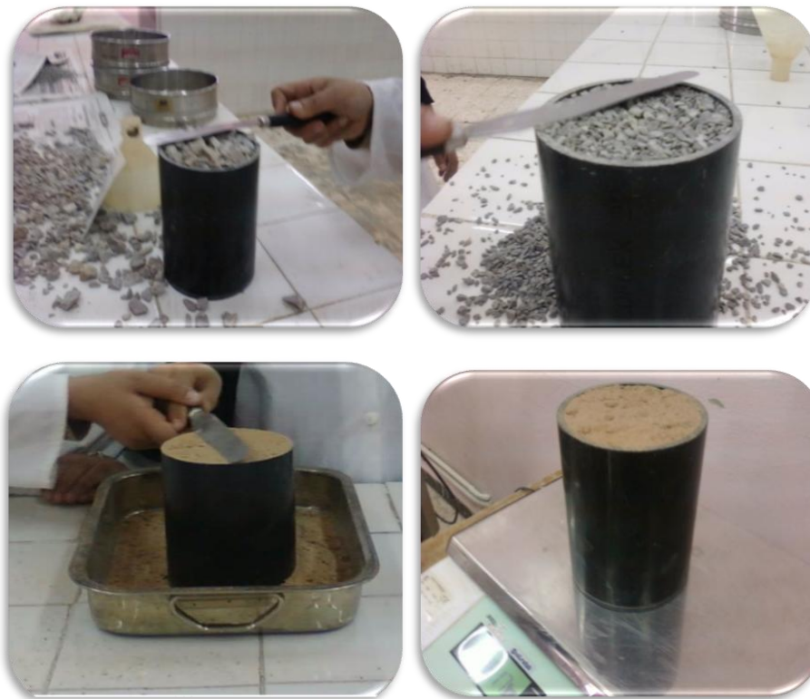
Figure III. 1 : Essai de la masse volumique apparente
