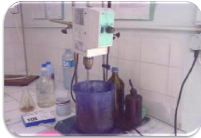
Figure III. 11: Essai bleu de méthylène.
