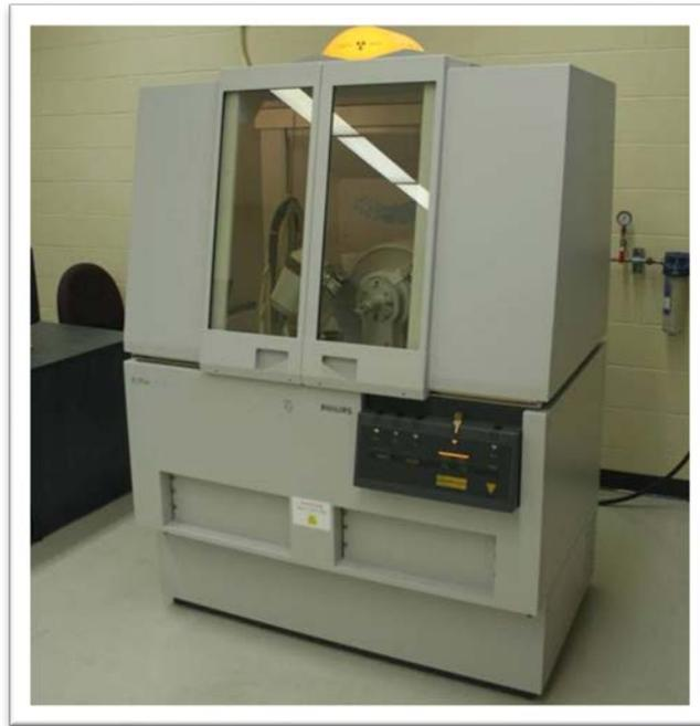
Figure V.18 : Machine de diffraction des rayons X
