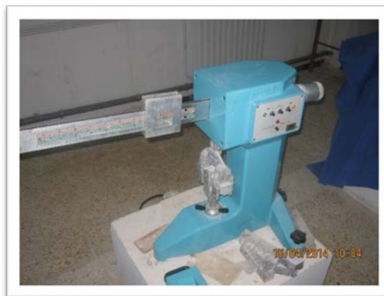
Figure VI.17 : Machine d'essai de résistance à la flexion.
