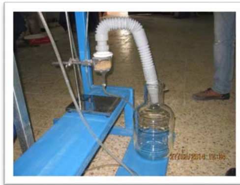
Figure VI.21 : Le dispositif miniature pour le traitement de 50g de sable.
