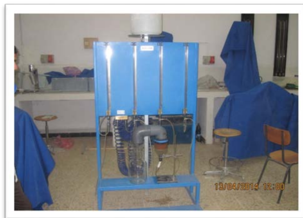
Figure VI.22 : Le dispositif du traitement hydraulique pour le traitement d'un kilo de sable.
