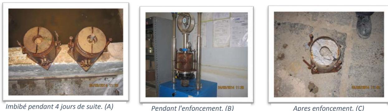
Figure VI.12 : Les étapes de l'essai CBR après immersion (Phases A, B, C)
