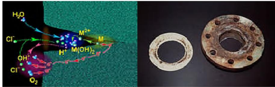
**Figure I.8.** Corrosion Caverneuse **Figure I.7.** Corrosion caverneuse d'un acier
