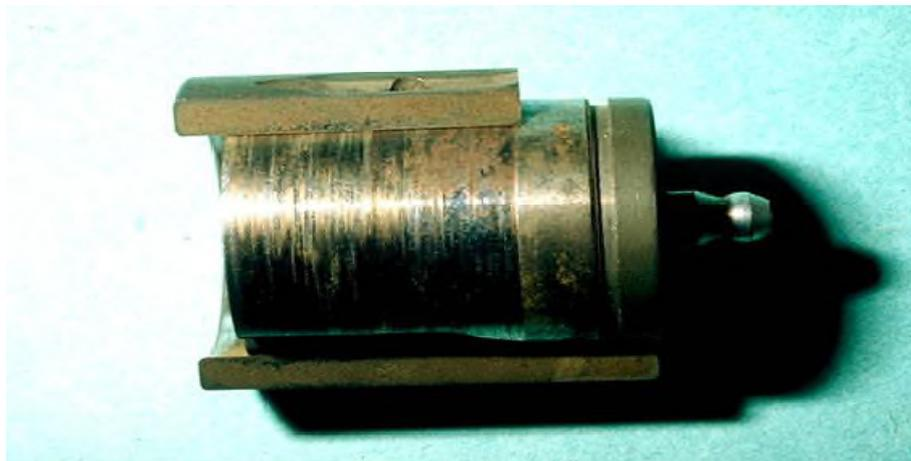
**Figure I.14.** Corrosion par frottement d'une pièce.
