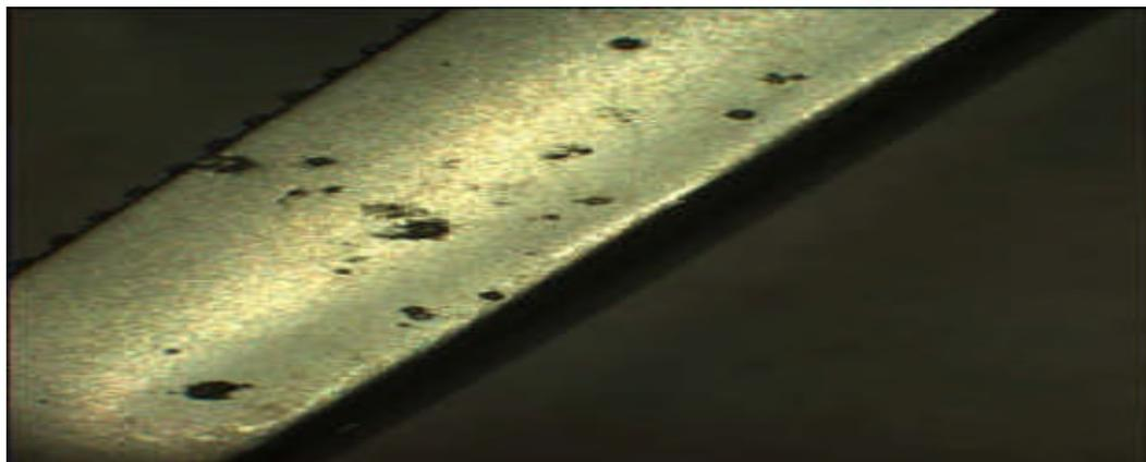
**Figure I.12.**Corrosion par piqûres (Amorçage (a) et propagation (b) d'une piqûre)
