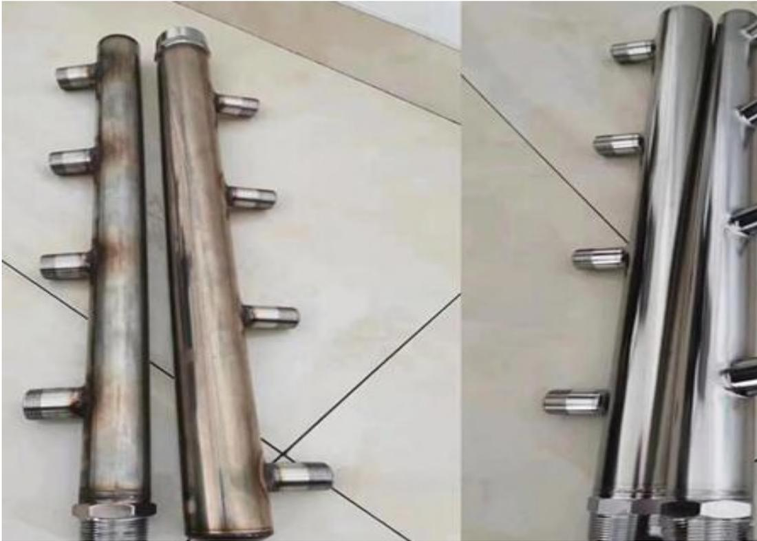
**Figure III-5.** avant et après décapage passivation
