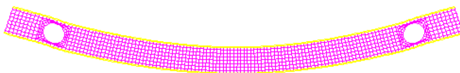
Poutre a-2: déformation
