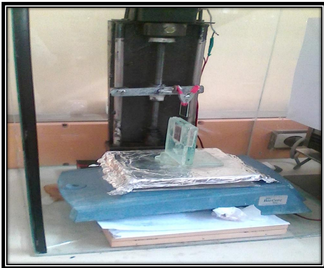
Figure III.5: Schéma représentant le principe de préparation des films minces par la méthode de trempage-tirage.
