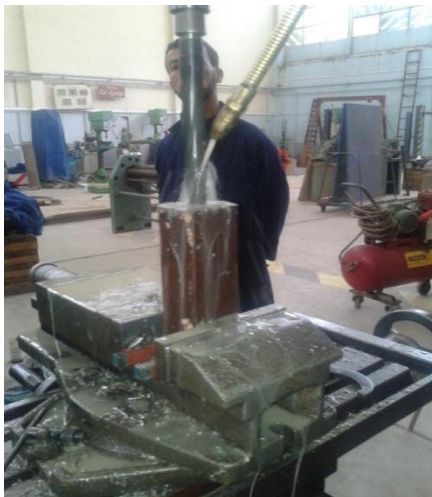
Figure III.17 : Perçage du contrepoids pour loger l'axe de liaison en rotation avec le troisième joint
