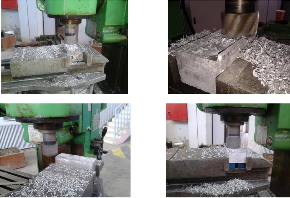
Figure III. 25 : Usinage de surfacage de la pièce par fraisage
