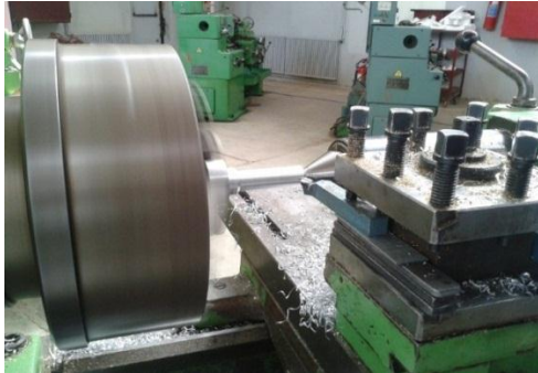
Figure III.29 : Tournage de l'axe du 6 ème joint
