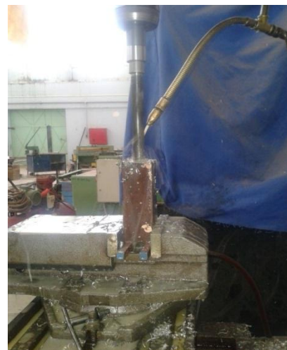
Figure III.17 : Perçage du contrepoids pour loger l'axe de liaison en rotation avec le troisième joint
