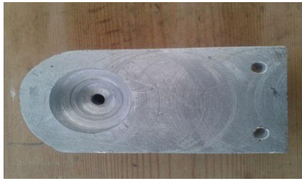
Figure III.34 : Erreur de définition de diamètre commise pendant le perçage de la loge du roulement, corrigée par l'insertion d'une bague
