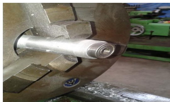
Figure III.31 : Tournage de la loge du roulement de guidage
