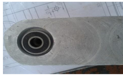
Figure III.34 : Erreur de définition de diamètre commise pendant le perçage de la loge du roulement, corrigée par l'insertion d'une bague
