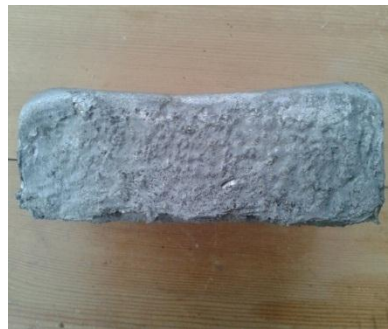
Figure III.22 : Pièces moulées en Aluminium
