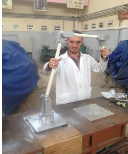
Figure III.37 : Proportions du bras par rapport à l'opérateur
