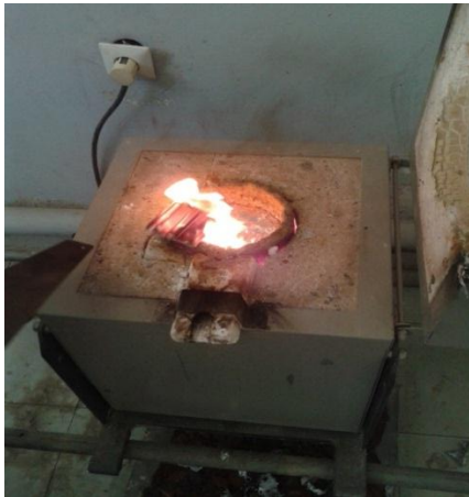
Figure III.21 : Fusion et moulage des pièces en Aluminium
