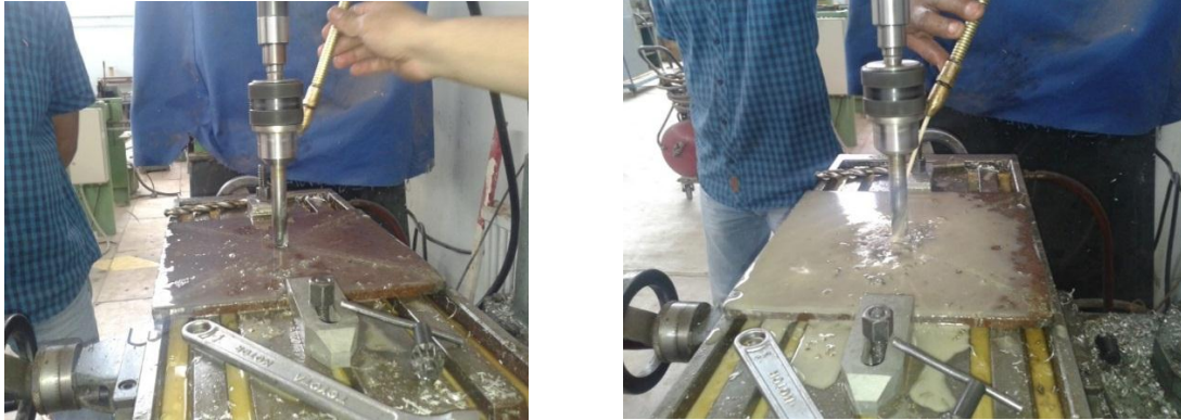
Figure III.13 : perçage de la base pour créer la poche du potentiomètre
