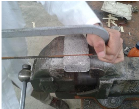
Figure III.23 : Traitement de la forme générale manuellement par scie à métaux
