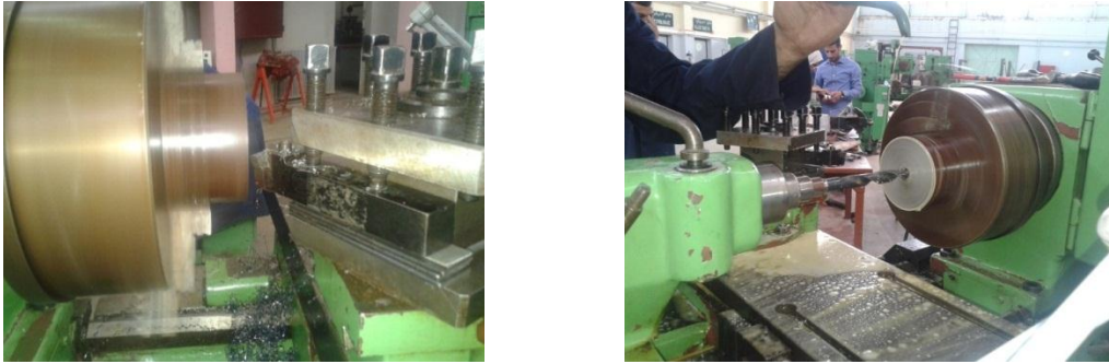
Figure III.15 : Traitement de surface par Tournage et Perçage de la Partie cylindrique de la base
