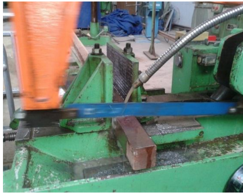
Figure III.16 : Sectionner le contre poids en acier par la scie mécanique
