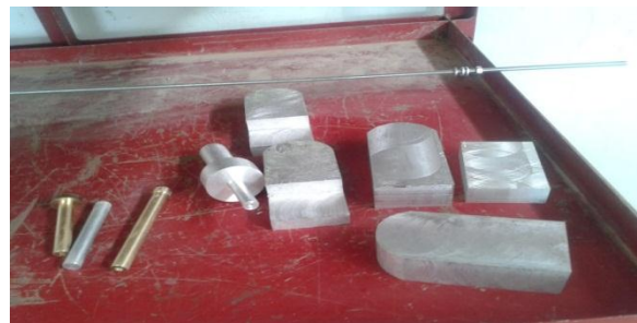
Figure III.30 : Les pièces en Aluminium et bronze semi-finies
