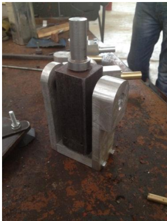
Figure III.19 : Le premier joint de la chaîne articulée est composé d'un assemblage de 3 pièces en Aluminium sous forme d'un U
