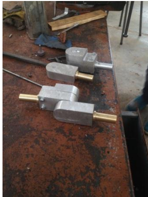
Figure III.35 : Articulations assemblées (à gauche), et montées avec les joints en PVC (à droite)
