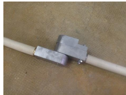
Figure III.35 : Articulations assemblées (à gauche), et montées avec les joints en PVC (à droite)
