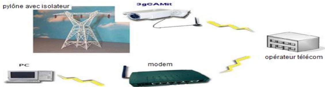
Figure I.10 Equipement nécessaire pour le déploiement du processus
