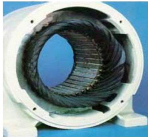
b) Damage dû à la surcharge
