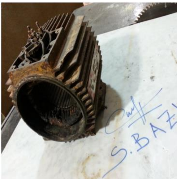
Figure (I.06): Stator d'un moteur asynchrone complètement grillé [5]
