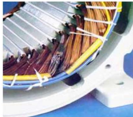
d) Dégradation causée par une surtension
