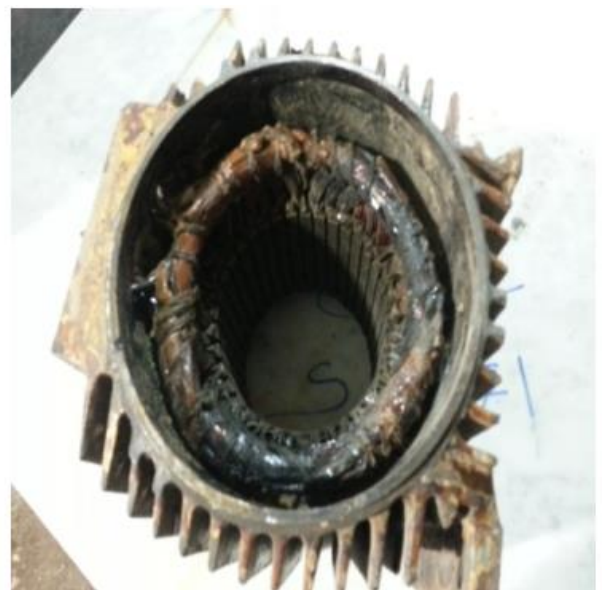
Figure (I.06): Stator d'un moteur asynchrone complètement grillé [5]
