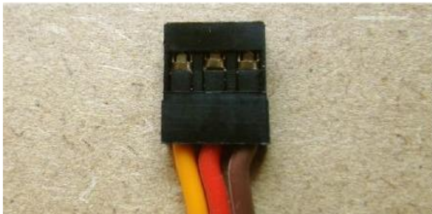
Figure II- 18: Fiche de commande d'un servomoteur
