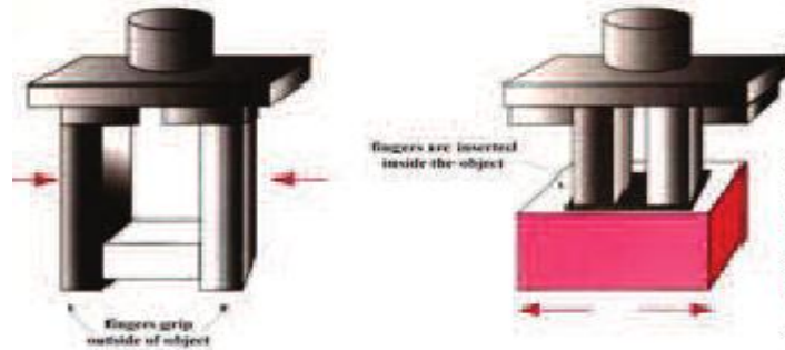
Figure I- 14: Serrage intérieur et extérieur
