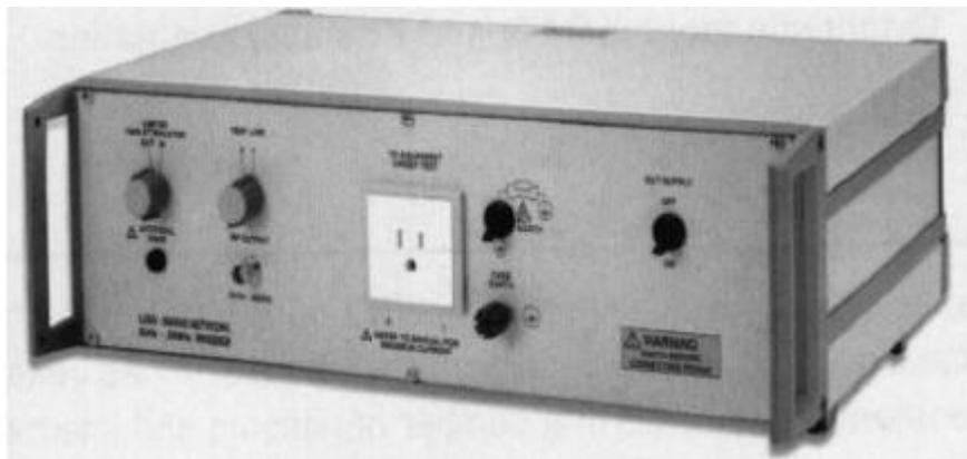
Fig. III.20 : Photo représentant un RSIL monophasé utilisé en CEM [7]
