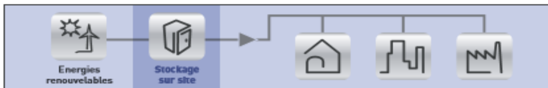
Figure .III.14- Stockage distribué de l'électricité.
