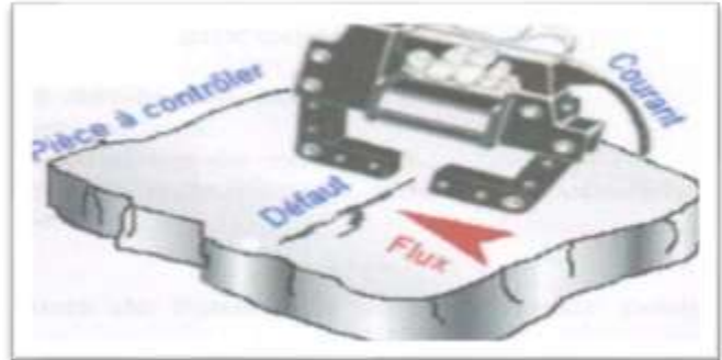
Figure II.3 : Principe de la magnétoscopie
