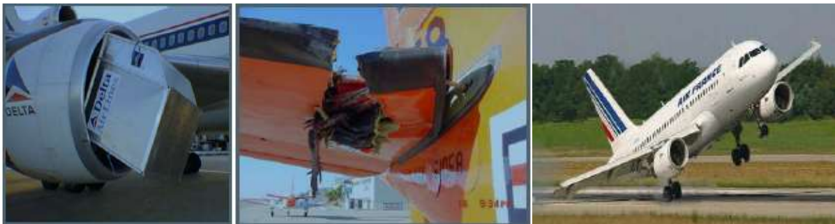
Figure I.5: Exemples de dommages survenus lors de phases aux sols, décollages et atterrissages de différents avions [21].
