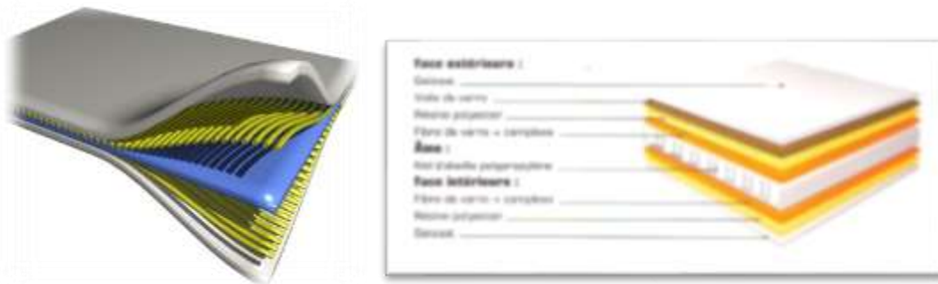
Figure I.7 : Les structures composites simples et en sandwich.
