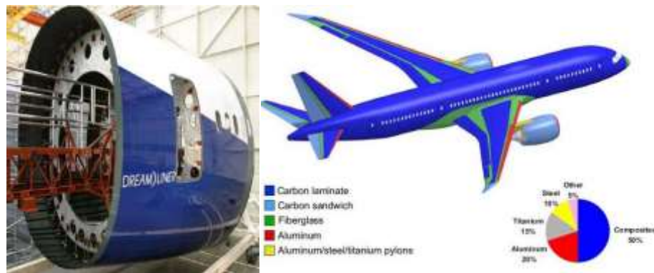
Figure I.4: Fuselage et structure du Boeing 787 montrant les différents matériaux utilisés [17]
