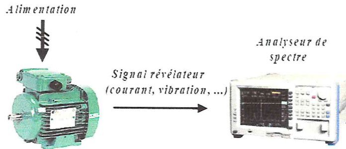
Figure I.14: Principe de la surveillance par analyse spectrale
