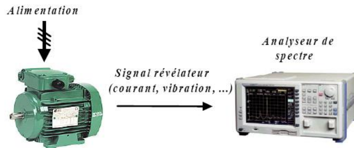
Figure I.14: Principe de la surveillance par analyse spectrale
