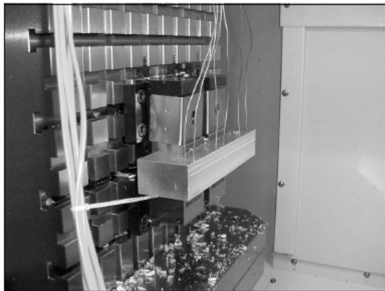
Figure I.19 : Photographie des thermocouples incorporés [18].
