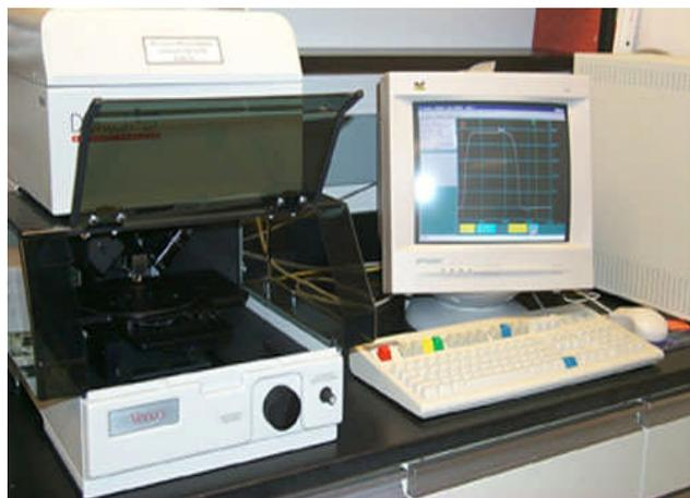
Figure IV.33 : Le profilomètre Dektak III.
