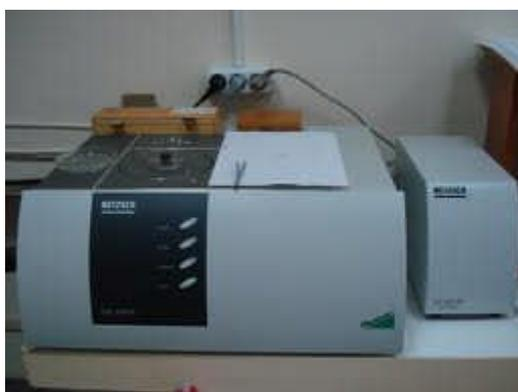
**Figure IV.4 :** L'analyseur enthalpique différentiel NETZSCH DSC 204F1.
