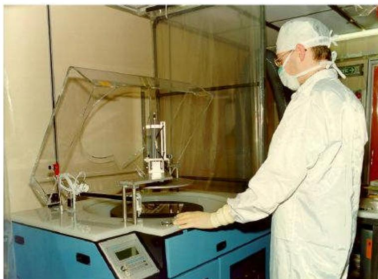
**Figure III.4 :** Spin-coating réalisé en salle propre [wiki].
