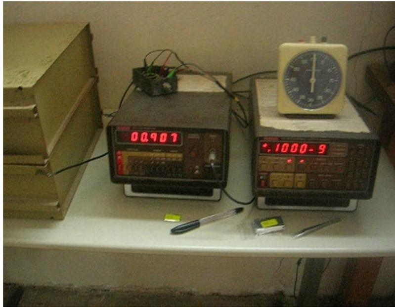
**Figure IV.23 :** Dispositif à quatre pointes.
