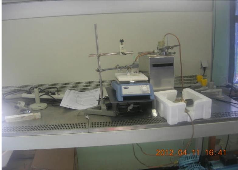
**Figure IV.31 :** Représentation du dispositif de Spray-pyrolyse ultrasonique
