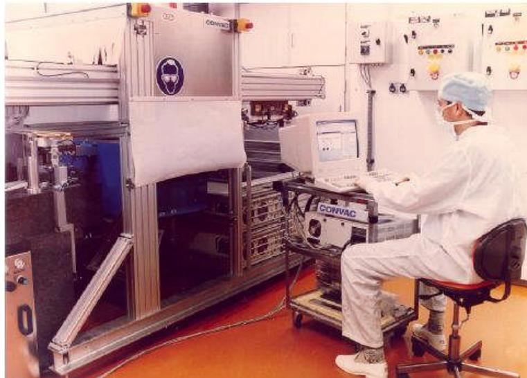
**Figure III.5 :** Enduction laminaire réalisée en salle propre [wiki].
