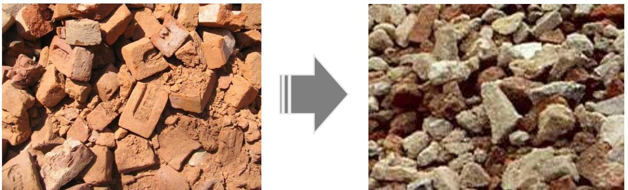
**Figures I.2** : Granulats de Débris de Maçonneries [5].
