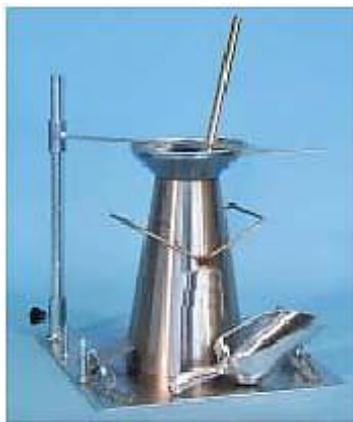
Figure II.1: Le cône d'Abrams
