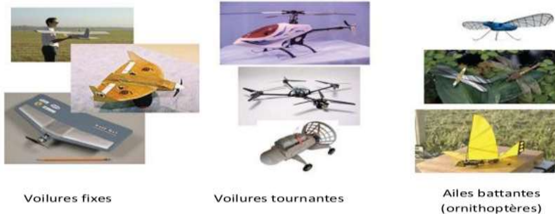
Image I.11. Classification des drones selon le mode de propulsion.
