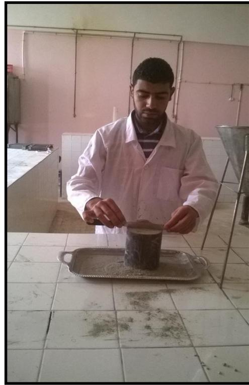
Fig. V.4 : Essai de la masse volumique du ciment.
