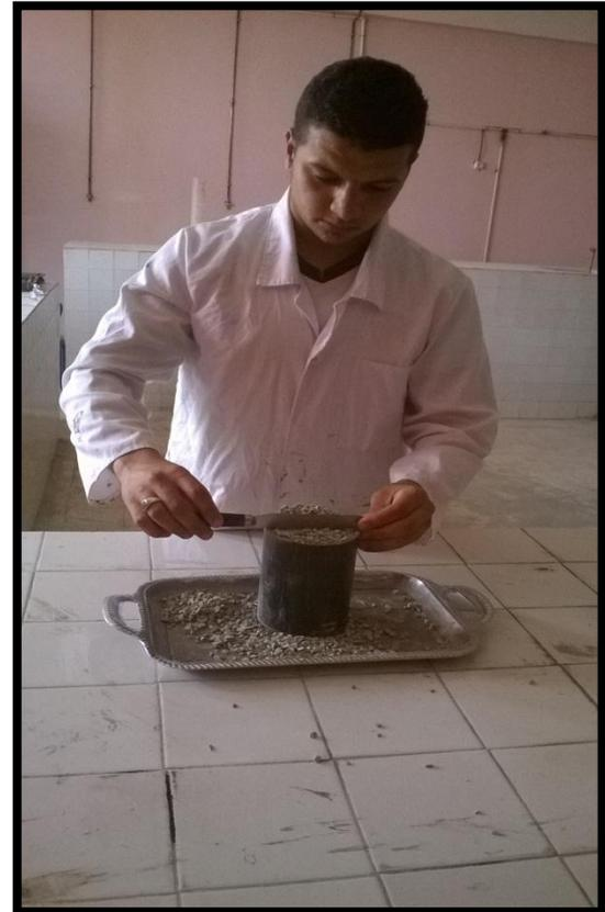
**Figure V.13: Essai de la masse volumique du gravier 3/8 et 8/15**
