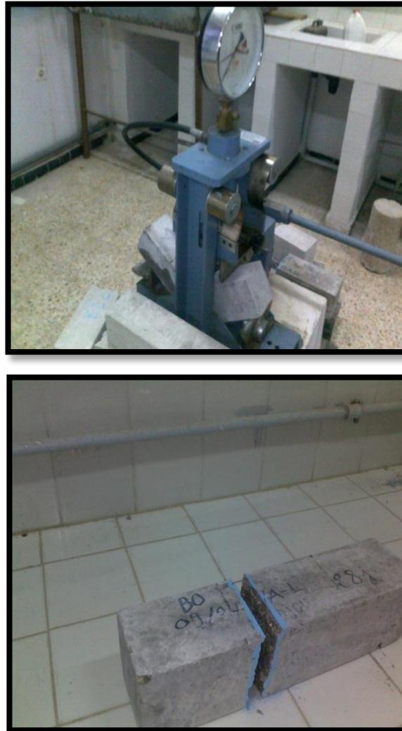
Figure V.25: Essai de traction par flexion quatre points
