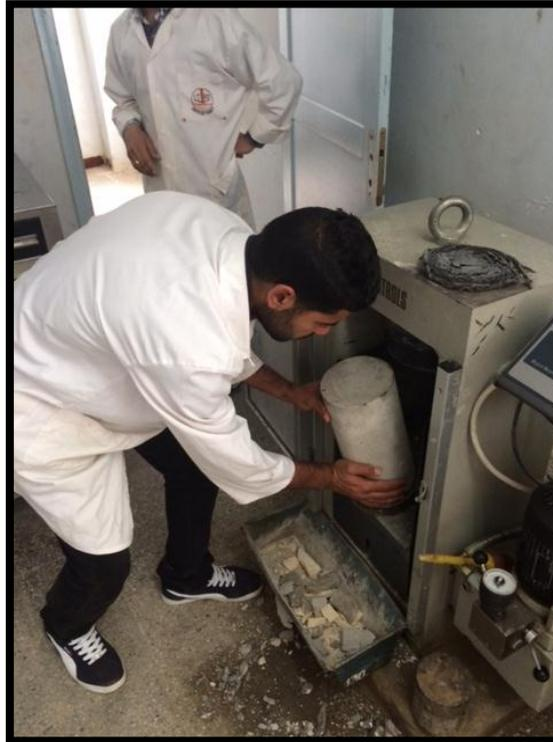
**Figure V.24: Machine pour essai de compression simple**
