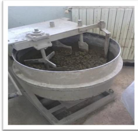
**Figure V.19 : malaxage du béton**
