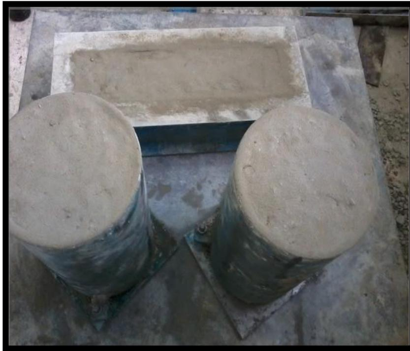
**Figure V.21 : Fabrication et vibration des éprouvettes cylindrique et prismatique.**
