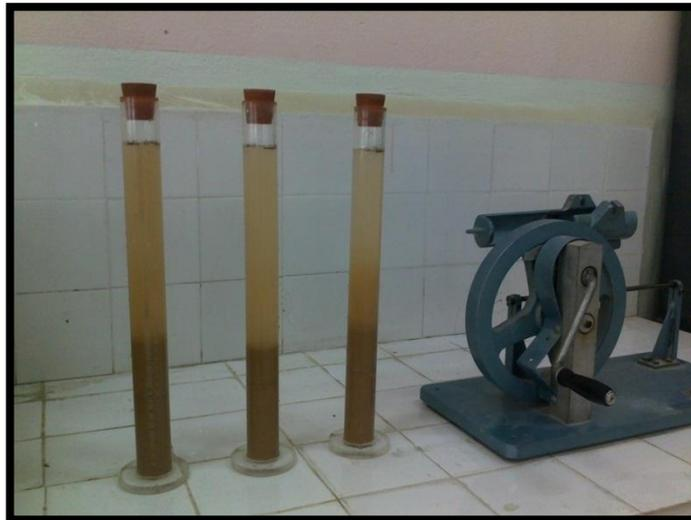
**Figure V.11: éprouvettes pour l'essai de l'équivalent de sable (ES)**
