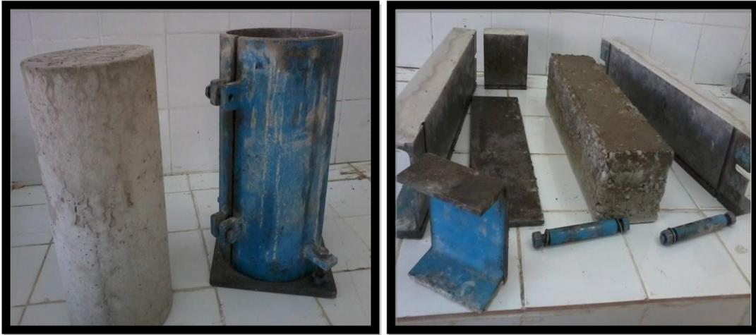
**Figure V.22 : Démoulage des éprouvettes cylindriques et prismatiques**
