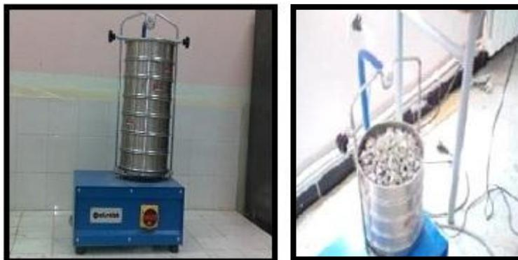
**Figure V.14 : Essai de l'analyse granulométrique du gravier (3/8 et 8/15)**
