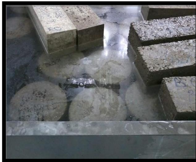
**Figure V.23 : Conservation des éprouvettes (cylindriques et prismatiques)**
