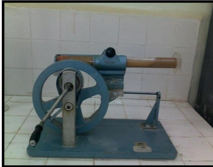
**Figure V.10: Machine d'agitation (mouvement rectiligne horizontale).**
