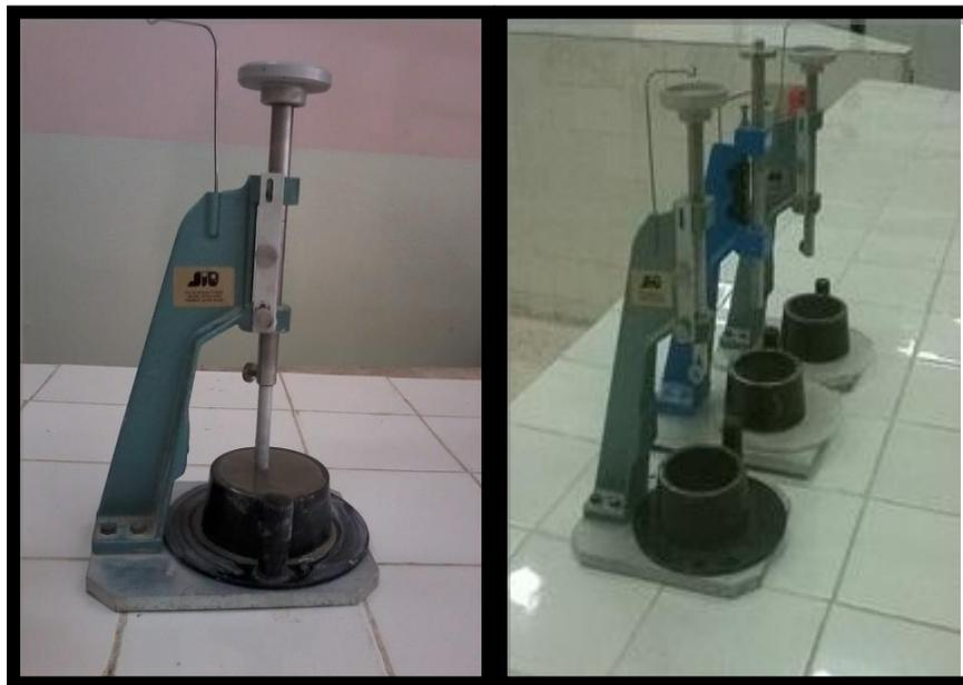
Figure V.8: détermination de la consistance et la prise des ciments
