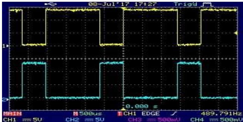
Figure (III.23): Signaux PWM de la commande et en mode complémentaire.
