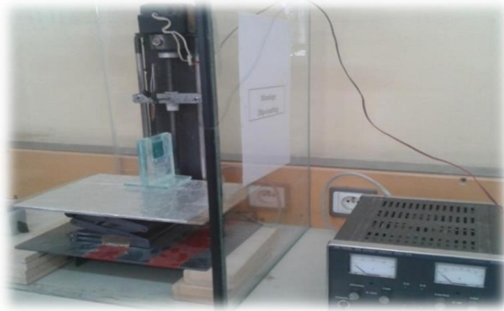
Figure III.14 : Le dispositif expérimental utilisé pour le dépôt « Dip-coating ».
