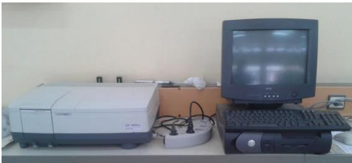
Figure II.24 : Schéma de spectrophotomètre à double faisceau de type SHIMADZU (UV 1650 PC)
