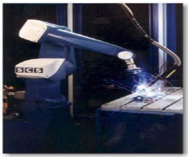
Figure I.20: Robot soudeurs a l'arc
