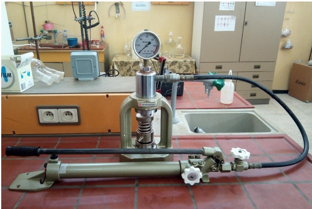
Figure III-7 : représentation de la pastilleuse utilisée pour compresser la poudre.
