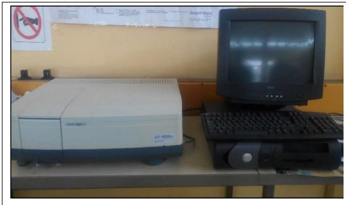
Figure II-7 : Spectrophotomètre UV-Visible de marque SHIMADZU UV1650 pc à double faisceaux.
