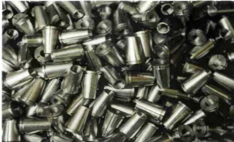
Photo X.1: clavettes en cours de fabrication
