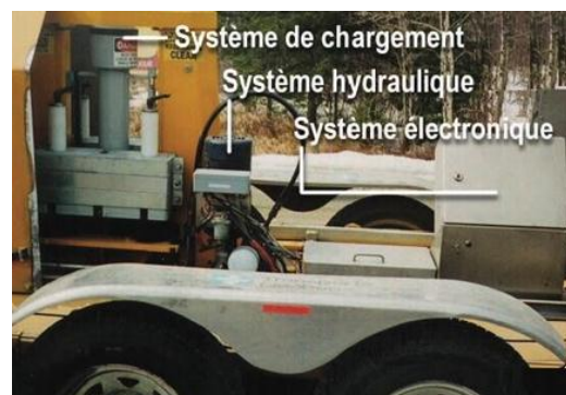
Fig.(II.8) Vue des trois systèmes principaux du déflectomètre.
