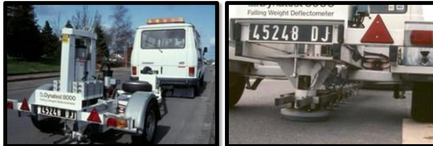
Fig.(II.7) FWD (Déflectomètre à masse tombante)
