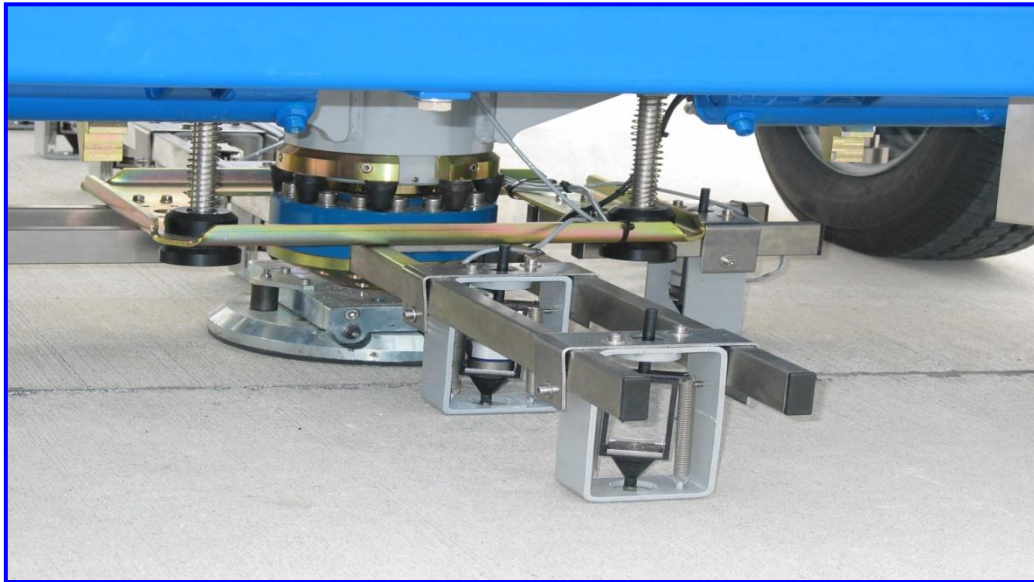
Fig.(IV.3) Positionnement des géophone- Structure rigide
