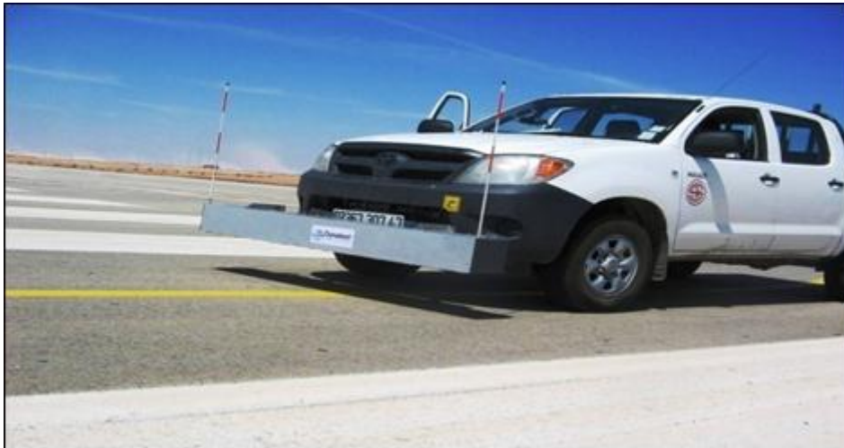
Fig.(III.27) Le profilomètre à laser RSP 5051 de marque Dynatest
