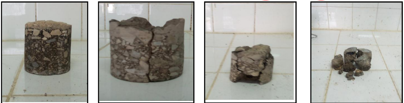
Fig.(III.35) Représentation des carottes de chaussée investiguée
