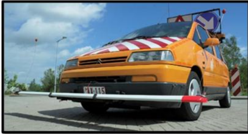
Fig.(II.13) Le TUS (Transverso-profilomètre à Ultra-Sons) mesure l'orniérage des revêtements.
