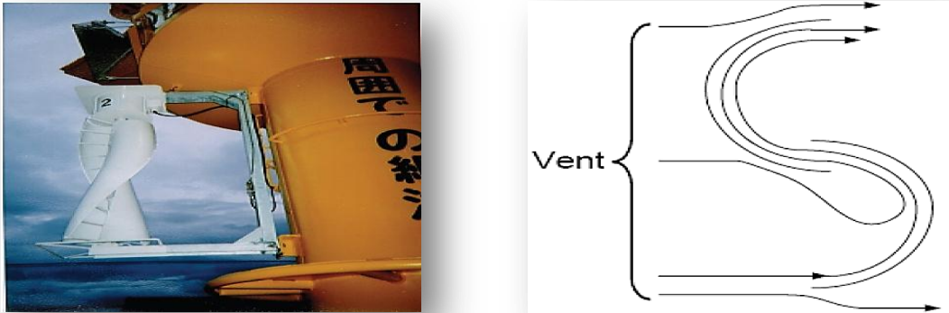
Figure I. 5 : Eoliennes à axe vertical à Rotor de Savonius
