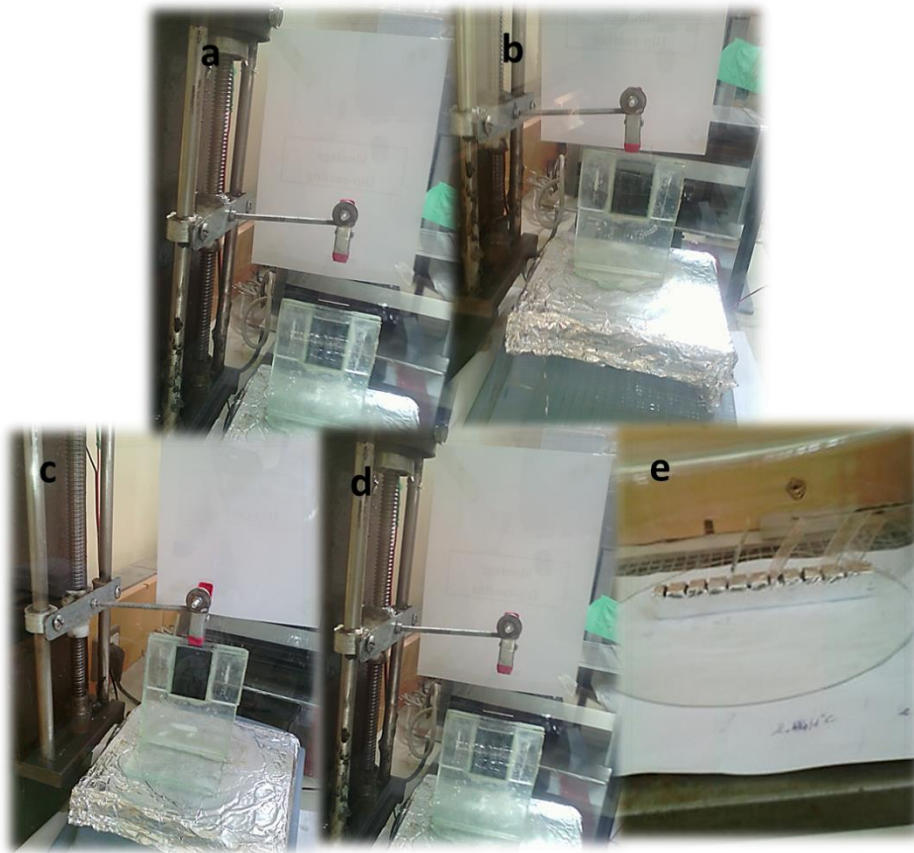
Figure III.17 : Étapes de la formation du film : (a) et (b) trempage ; (c) Repos 2 min ; (d) tirage (e) échantillons introduits dans l'étuve.
