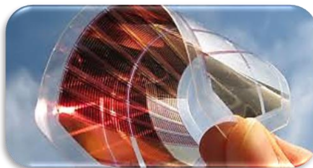
Figure I.2 : Cellules solaires organiques imprimée sur des substrats plastiques.
