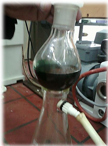
Figure III.12 : Solution de PANI colloïdale d'un précipité vert foncé.
