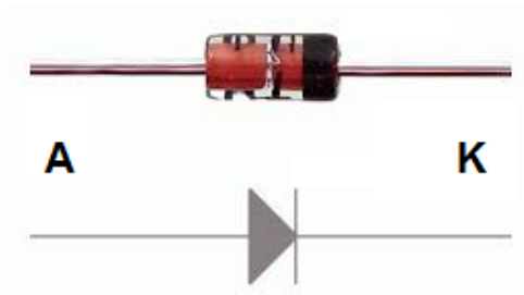
Figure III.6 : schéma diode de rééquilibrage 1N4148
