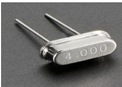
Figure III.3 : Oscillateur cristal à 4MHZ.
