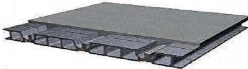
**Figure III.3 :** Plancher à corps creux (16+4) cm.
