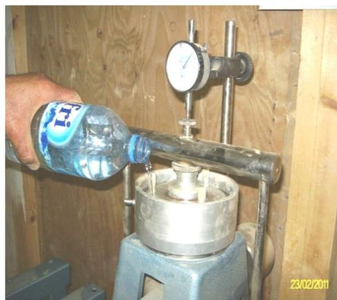
Figure 0.20: Mise en place et saturation de l'échantillon dans la cellule œdométrique
