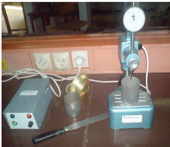
Figure 0.4: Essais de détermination de la limite de liquidité par le pénétromètre cône.
