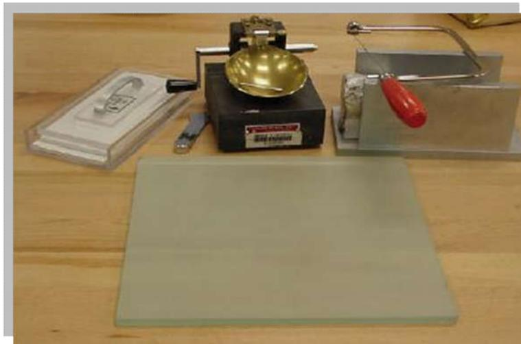
Figure 0.5: Appareil de Casagrande et outil à rainure
