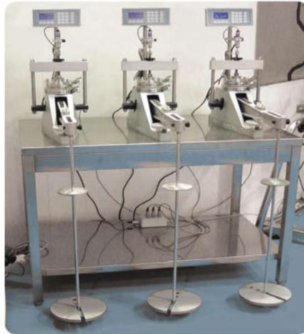
Figure 0.19: Schéma et principe de l'essai de compressibilité à l'œdomètre
