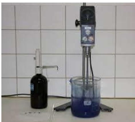
Figure 0.11: Appareillage pour essai au bleu de méthylène
