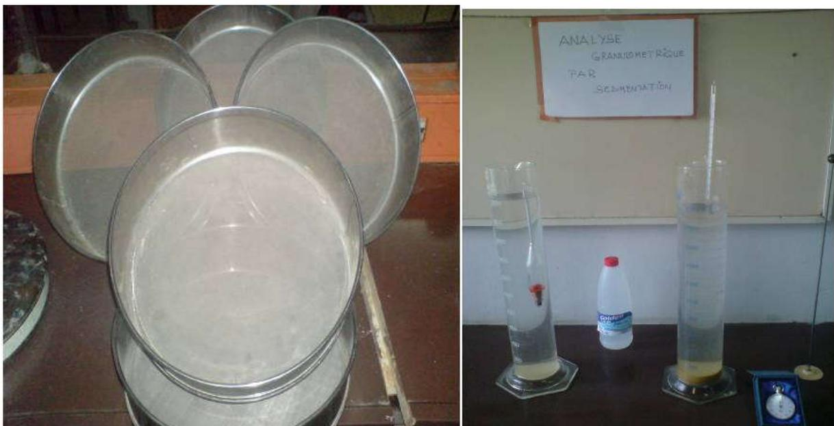
Figure 0.1: Essais granulométriques par tamisage et Sédimentométrie
