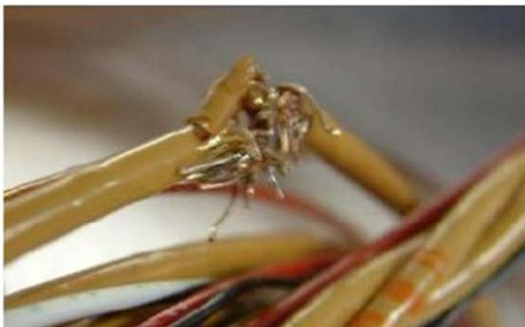
**Figure I.5** - Exemple d'un défaut franc : circuit ouvert [3].
