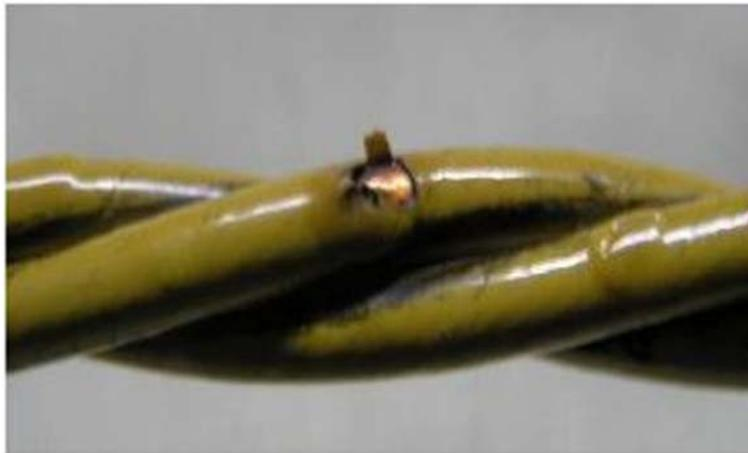
**Figure I.6** - Exemple d'un défaut non franc : dénudation d'un câble [3].
