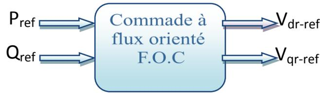
**Figure II-17:** Bloc de contrôle à flux orienté.
