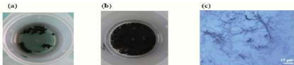
**Figure II.9:** L'influence de la dispersion des (CNTs) par ultrasons. (a) (CNTs) dans l'éthanol avant passage aux ultrasons. (b) Après 1 heure aux ultrasons. (c) Image microscope optique d'une gouttelette de base + (CNTs) après 2 heures de dispersion. Des agrégats sont encore présents. [Bozlar, 2009]
