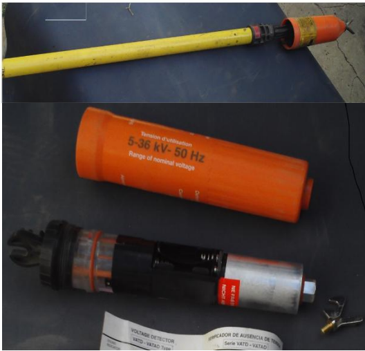
Fig.09 : Vérification d'absence de tension + perche.
