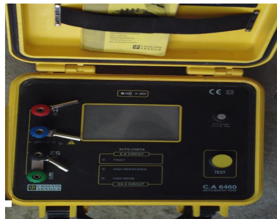
Fig.12 : appareil de mesure la résistance de la terre.
