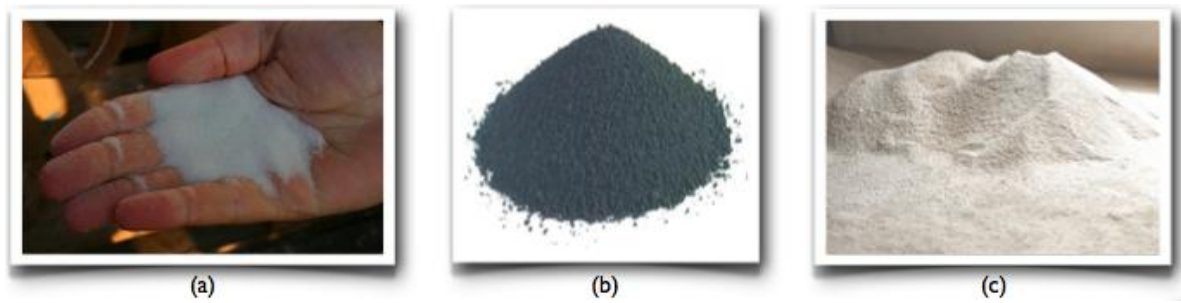
Figure I.11. Exemples des charges : (a) microbilles de verre, (b) noir de carbone, (c) silice.
