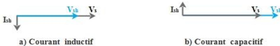
Figure 1.16 : Diagramme vectoriel du dispositif FACTS
