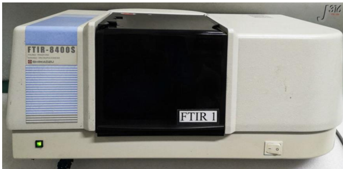
Figure II-11 : Spectrophotomètre FT-IR de type SHIMADZU FT-IR-8400
