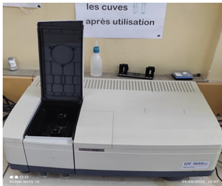
Figure II-7 : Spectrophotomètre UV-Visible de marque SHIMADZU UV-1650-PC à double faisceaux.
