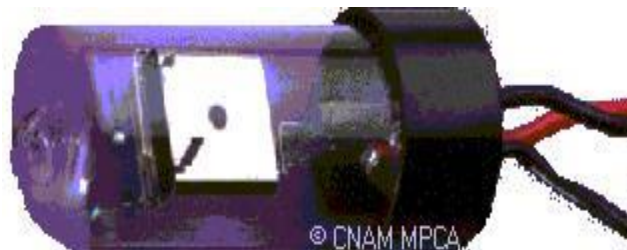
Fig.III.17. Lampe UV au deutérium
