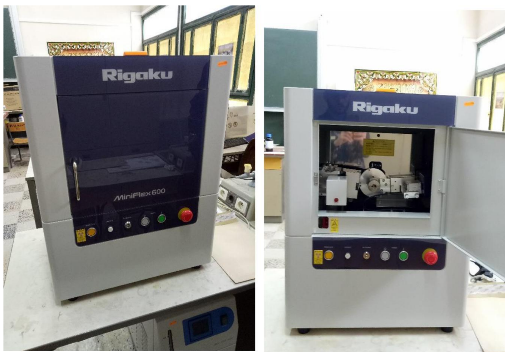
Fig.III.3. Diffractomètre de type Rigaku-MiniFlex600, disponible dans le L.S.C.T. Université Ibn Khaldoun Tiaret.
