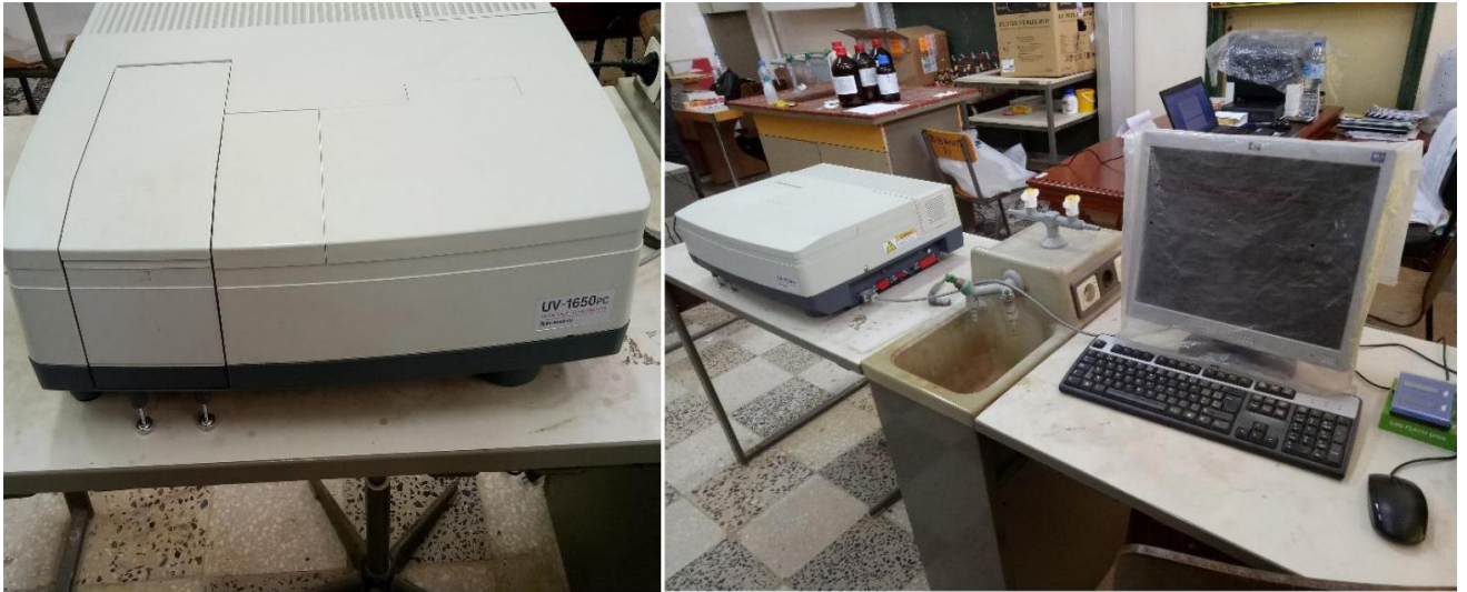
Fig.III.15. Spectrophotomètre UV-visible (UV-1650 pc. UV-VIS spectrophotomètre-SHIMADZU) (L.S.C.T)
