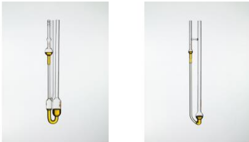
Figure II-3.: viscosimètre capillaire de type Ubbelohde et Ostwald respectivement.
