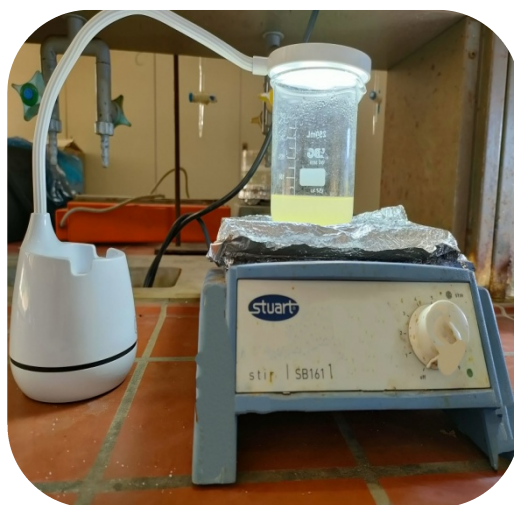
Figure II.13: Montage de la dégradation d'Orange G.
