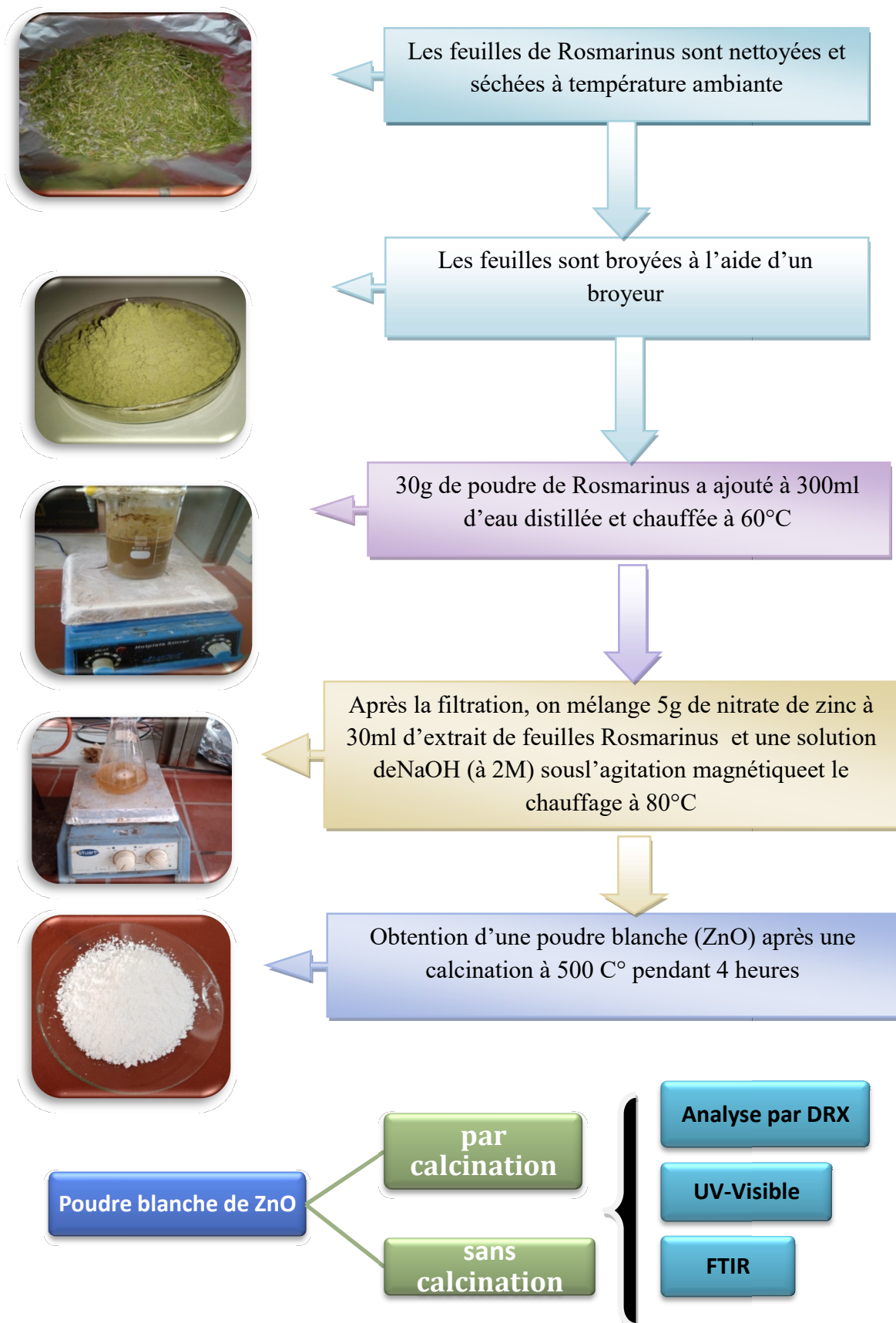
Figure II.4: Schéma de synthèse des nanoparticules ZnO par la plante Rosmarinus
