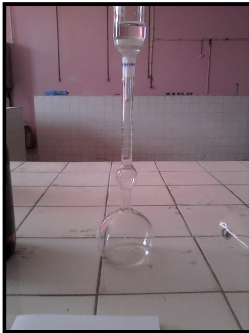
Figure (IV.4) : Chatelier pour essais de la masse volumique absolue
