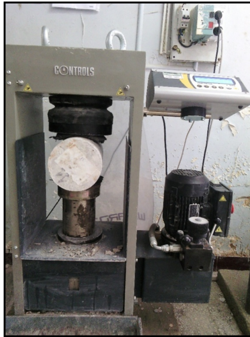
Figure (IV.27) : Machine d'essai de traction par fendage
