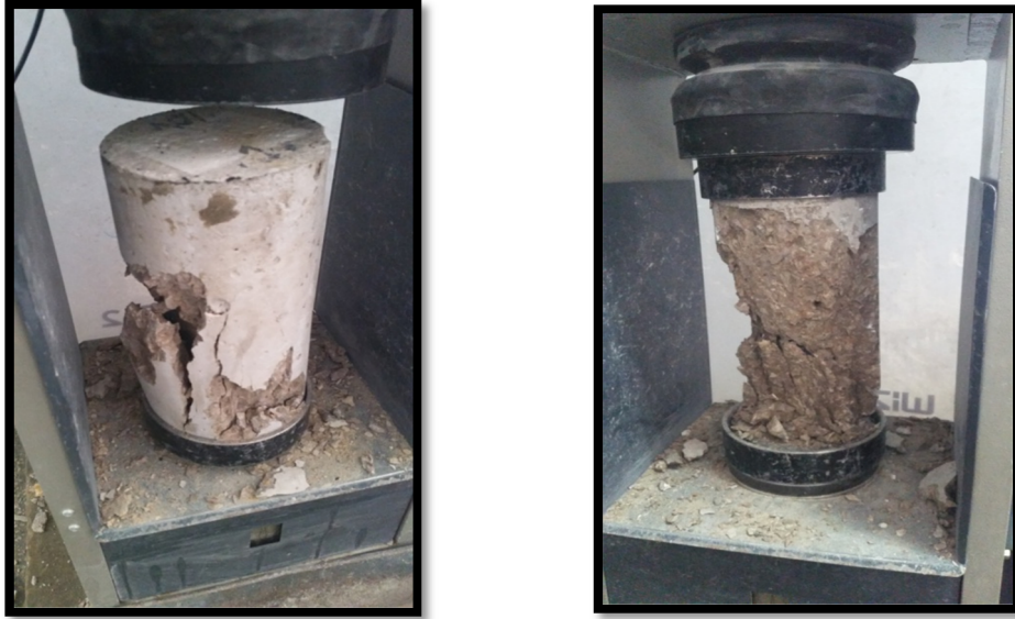
Figure (IV.26) : Rupture des éprouvettes cylindriques
