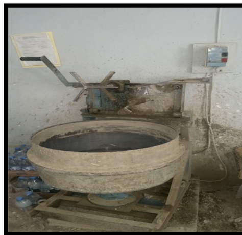
Figure (IV.17) : Malaxeur du béton
