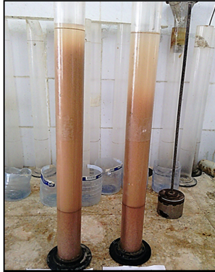
Figure (IV.12) : Essai d'équivalent de sable (juste après agitation)
