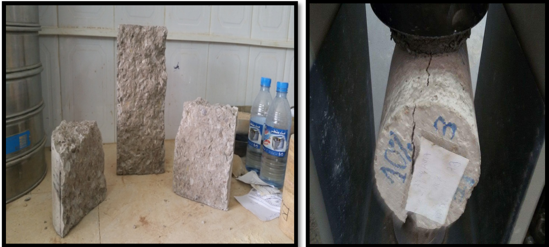
Figure (IV.29) : Rupture des éprouvettes cylindriques
