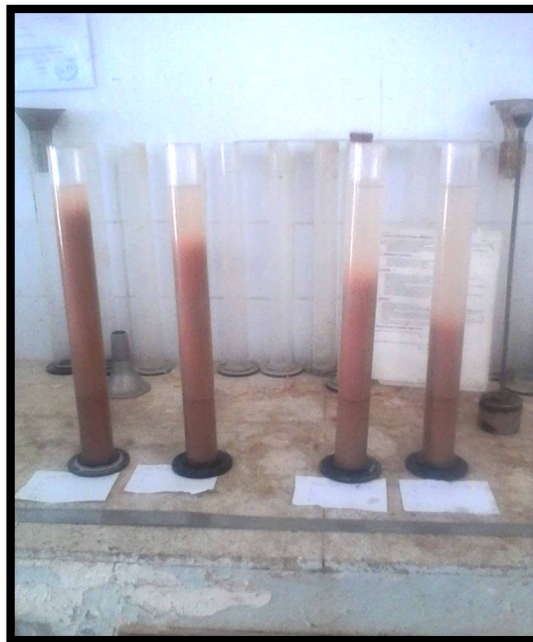
Figure (IV.10) : Equivalent de sable
