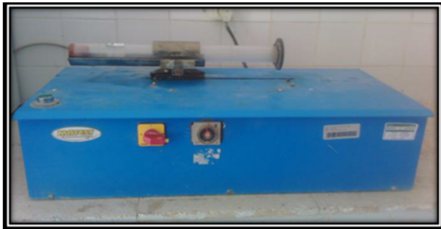
Figure (IV.11) : Machine d'agitation (mouvement rectiligne horizontal)
