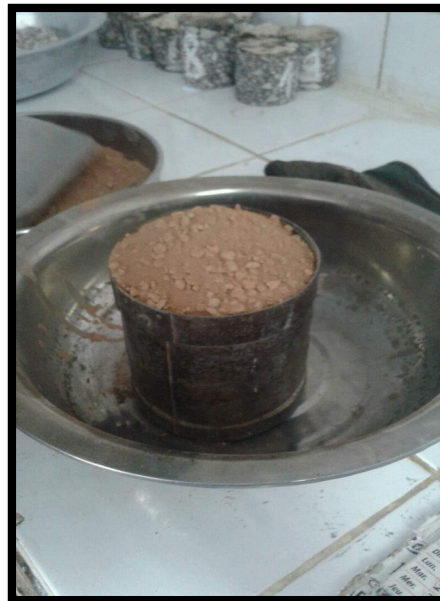
Figure (IV.7) : Détermination de masse volumique apparente de déchet de brique
