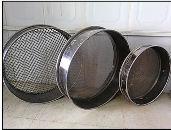
Figure (IV.15) : Tamis pour essai d'analyse granulométrique
