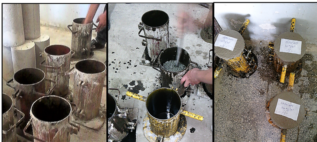
Figure (V.22) : Moulage des éprouvettes cylindriques
