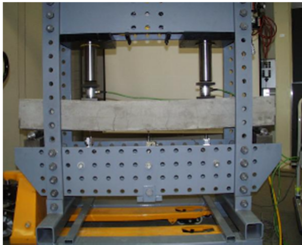
Figure (I.8) : Essai de flexion quatre points
