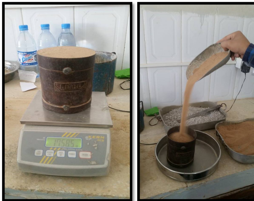
Figure (IV.9) : Détermination la masse volumique absolue et apparente
