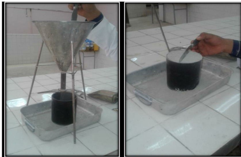
Figure (IV.2): détermination de la masse volumique apparente
