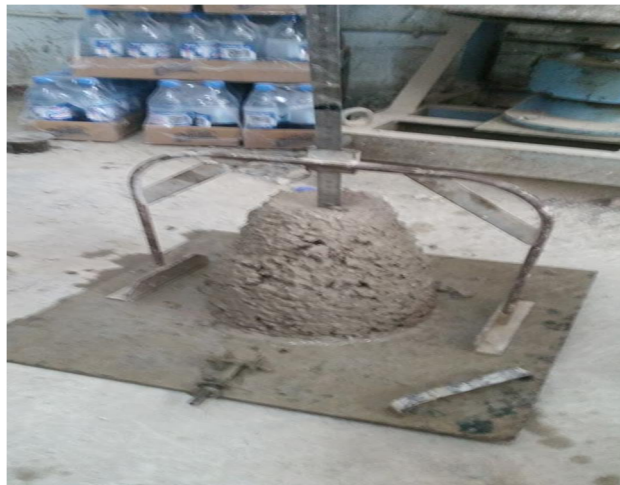
Figure (I.5) : Mesure de l'affaissement
