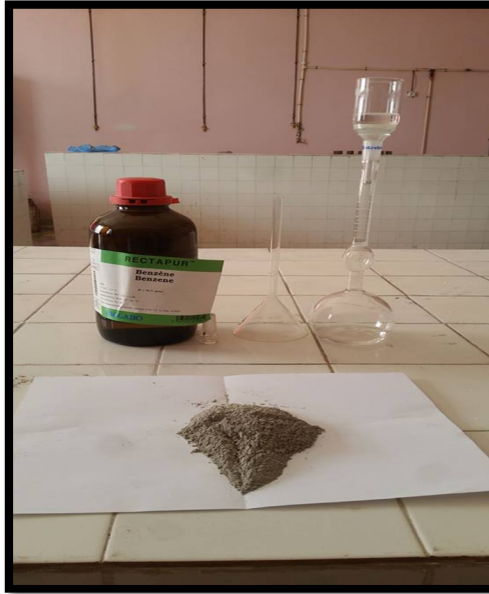
Figure (IV.3) : Détermination de la masse volumique absolue
