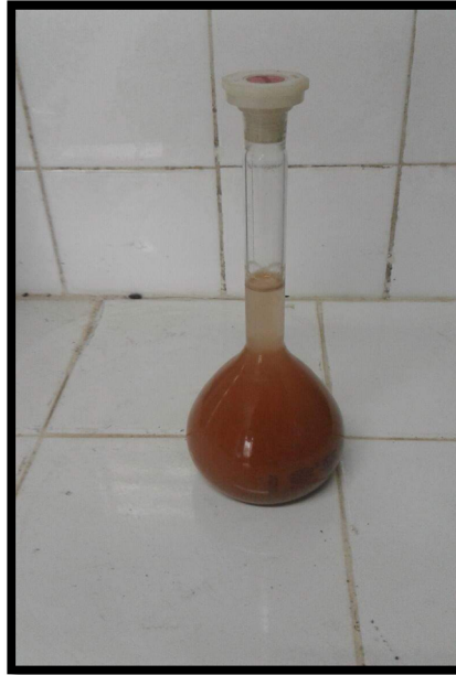
Figure (IV.6) : Détermination de masse volumique absolue de déchet de brique
