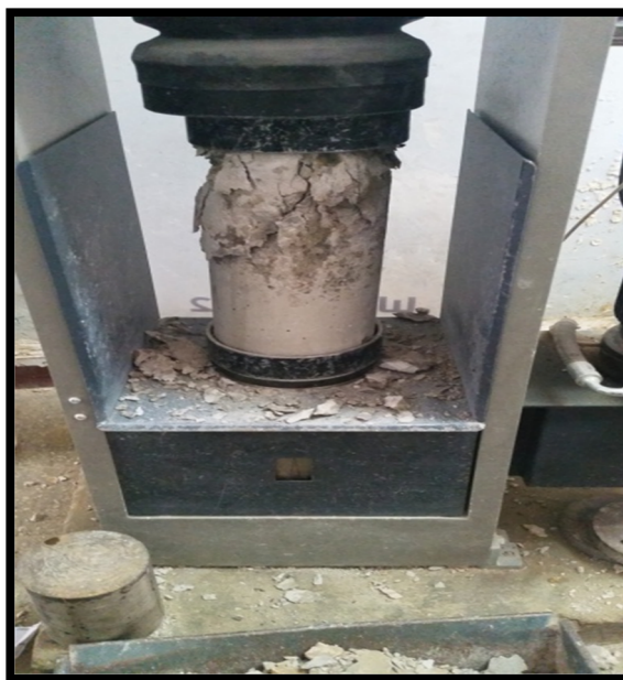
Figure (IV.25) : Rupture des éprouvettes cylindriques (Béton ordinaire)
