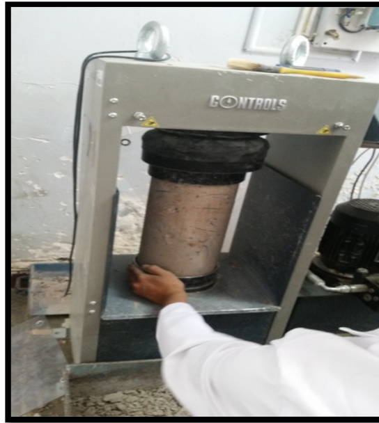
Figure (IV.24) : Chargements des éprouvettes cylindriques 16x32 cm (Essai de compression)
