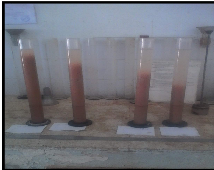
Figure (IV.13) : Les éprouvettes pour l'essai de l'équivalent de sable (Es) (phase de repos (20 mn))
