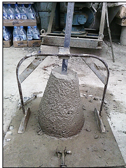
Figure (IV.21) : Détermination de l'affaissement du béton
