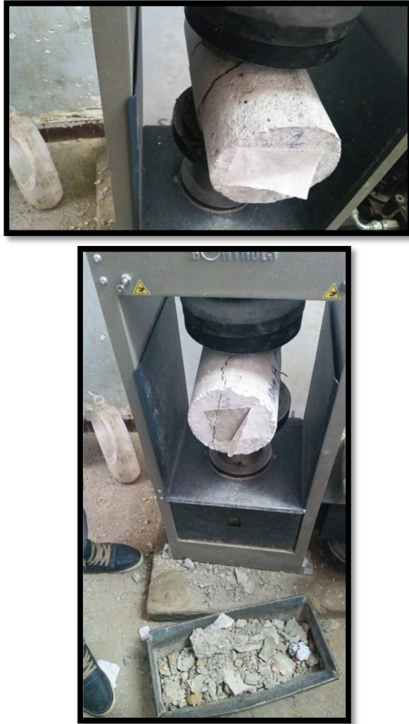
Figure (IV.28) : Rupture des éprouvettes cylindriques à 28 jours
