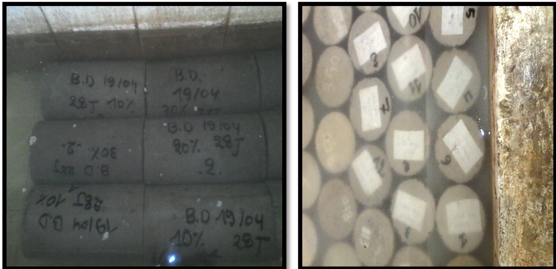
Figure (IV.23) : Conservation des éprouvettes cylindriques
