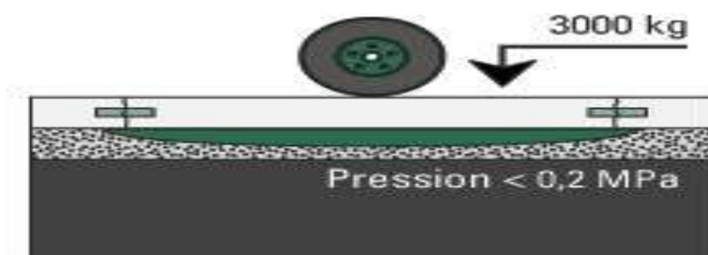
Figure IV. 11: Fonctionnement de la chaussée rigide
