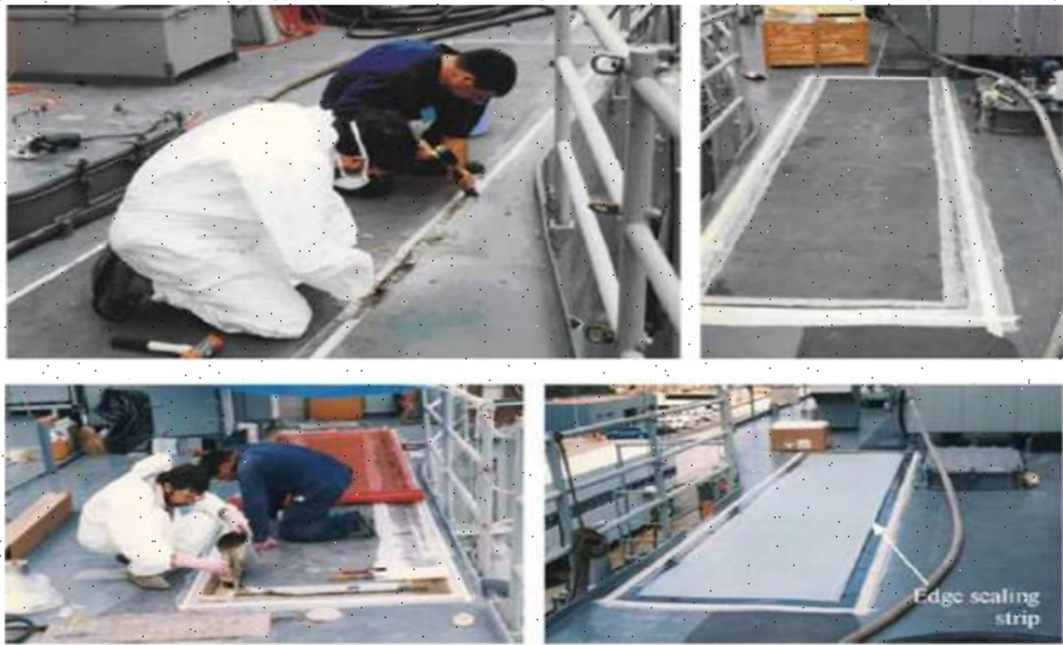
Figure II.3.10. Réparation de superstructure d'un navire en aluminium par patch composites[54].
