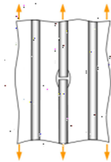
Figure II.4.7 Mécanisme rupture de fibre
