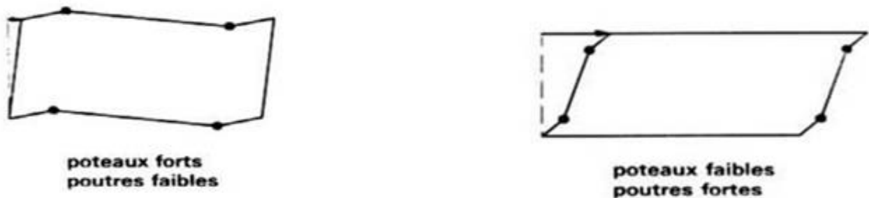
Figure 1.23 : Apparition des rotules plastiques
