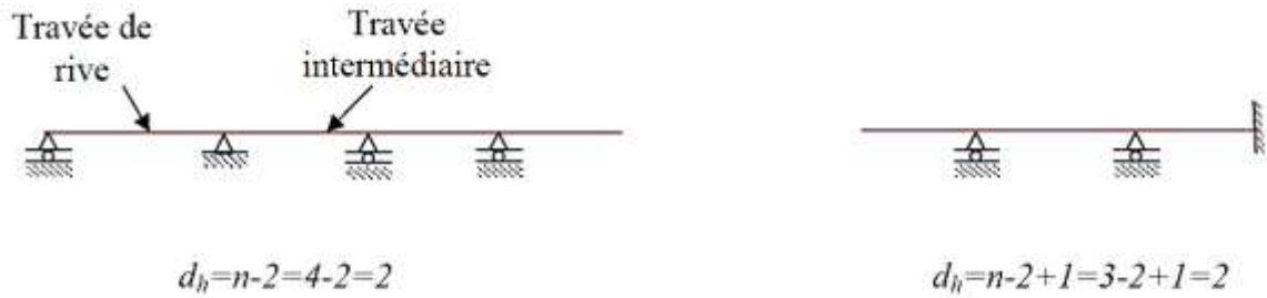
Figure 4.1 Degré d'hyperstaticité (raisonnement sur appuis)
